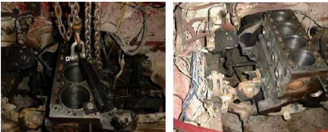
Dos vistas del bloque Fiat instalado en el vano motor del Niva. Nótese en la 2° foto que el Niva de Pierre tiene el volante a la derecha, esto hace el proyecto bastante más complicado.
