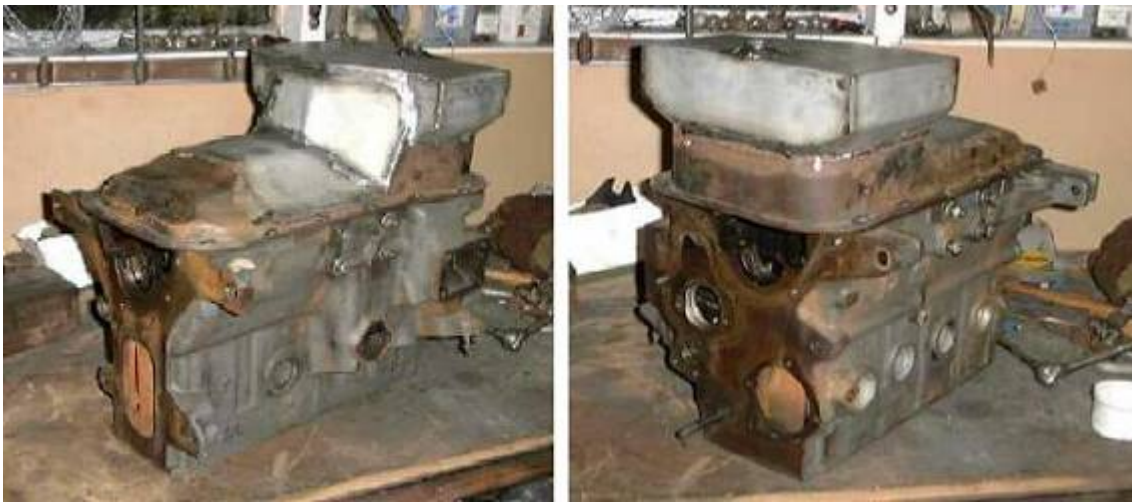
Dos vistas del cárter ya terminado y fijado al bloque
