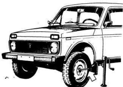
Рис. 54. Подъем автомобиля при замене колес
