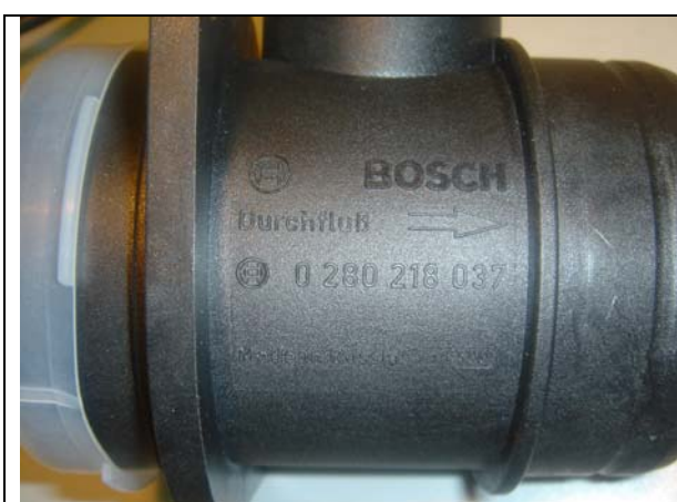
Надпись BOSCH имеет более сглаженную структуру букв
