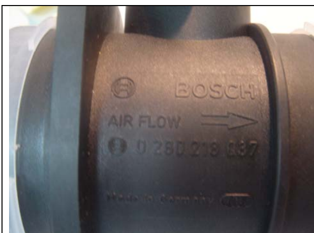
Надпись AIR FLOW выполнена в два слова, с пробелом
