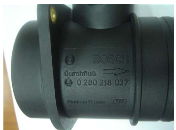
Надпись BOSCH имеет более выпуклую структуру букв
