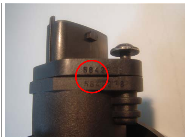
На корпусе чувствительного элемента и ДМРВ проставлена дата изготовления
