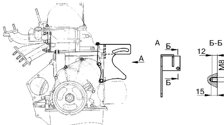
Рис.1. Выполнение отверстия в блоке цилиндров для крепления кронштейна насоса.
