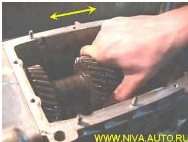
El desplazamiento axial se debe a un eje intermedio defectuoso, con desgaste pronunciado o a que los rodamientos del eje intermedio están destruidos. Ello puede ser la causa de ruidos en la caja.
