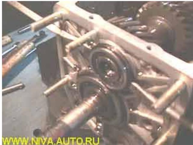
Se desplaza el eje intermedio hasta que el engranaje de la 1ra velocidad salga por la abertura, y luego se levanta hacia arriba y hacia afuera del cárter:
