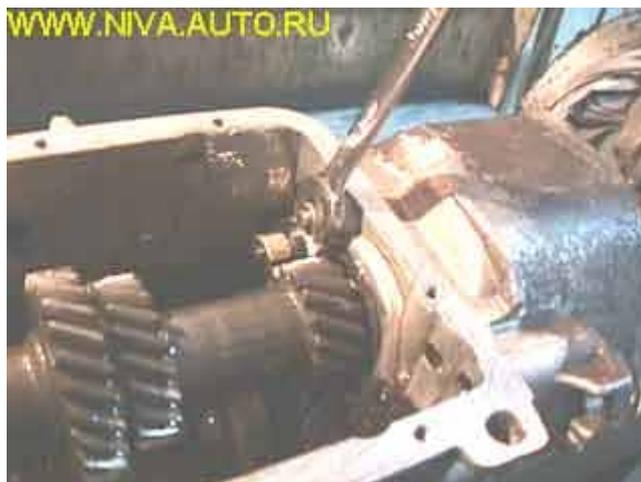
Golpeando con un mazo de goma, desprendemos la junta de la tapa trasera y la removemos con las manos:
