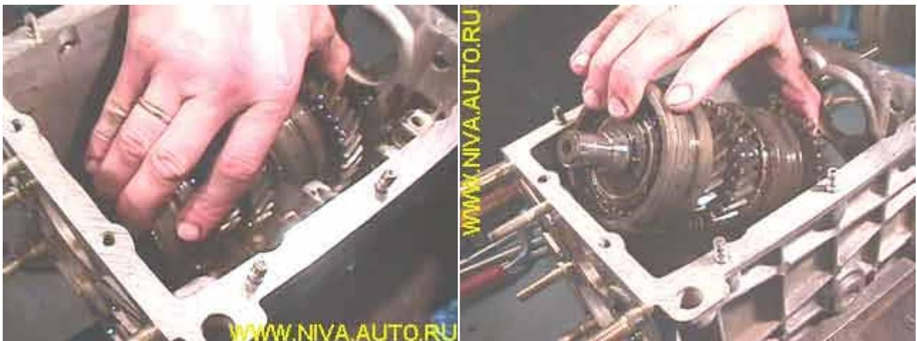
Quitamos del eje secundario el engranaje de 1ra velocidad, el manguito de 1ra-2da y su cubo, el engranaje de 2da velocidad y el manguito de 3ra-4ta. El cubo de 3ra-4ta y el engranaje de 3ra solamente se remueven si existen problemas en estas velocidades. Para esto es necesario remover antes el anillo de retención:
