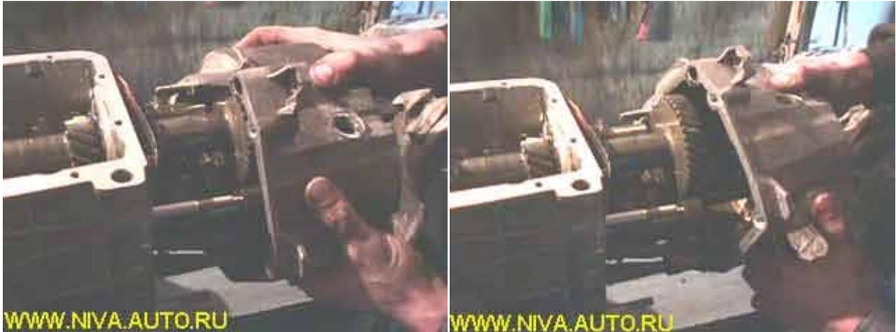
En la tapa deben quedarse las pistas externas junto con los rodillos de dos rodamientos. Si la pista interna del rodamiento del eje secundario se queda en este, quitar la tapa será imposible, es necesario empujarla hacia adentro hasta que la pista quede en el eje.
